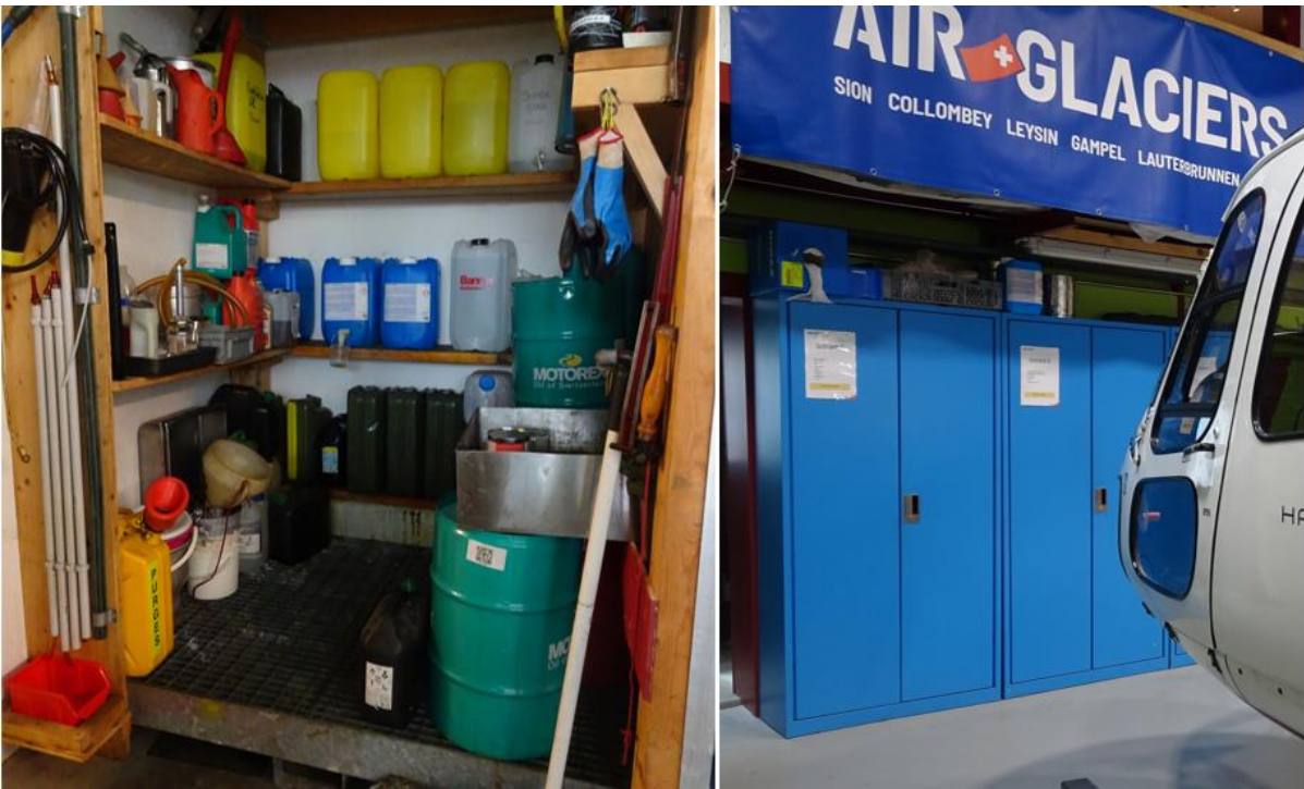
Abbildung 2-29: Links die Auffangwanne mit Getriebeöl und Treibstoffen, Rechts die Sicherheitsschränke der Werkstatt, Bächtold & Moor AG, Stand 16.04.2024.
