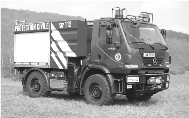
*Beispiel eines Tanklöschfahrzeuges mit 1'000 – 1'400 Liter Löschwasser*
