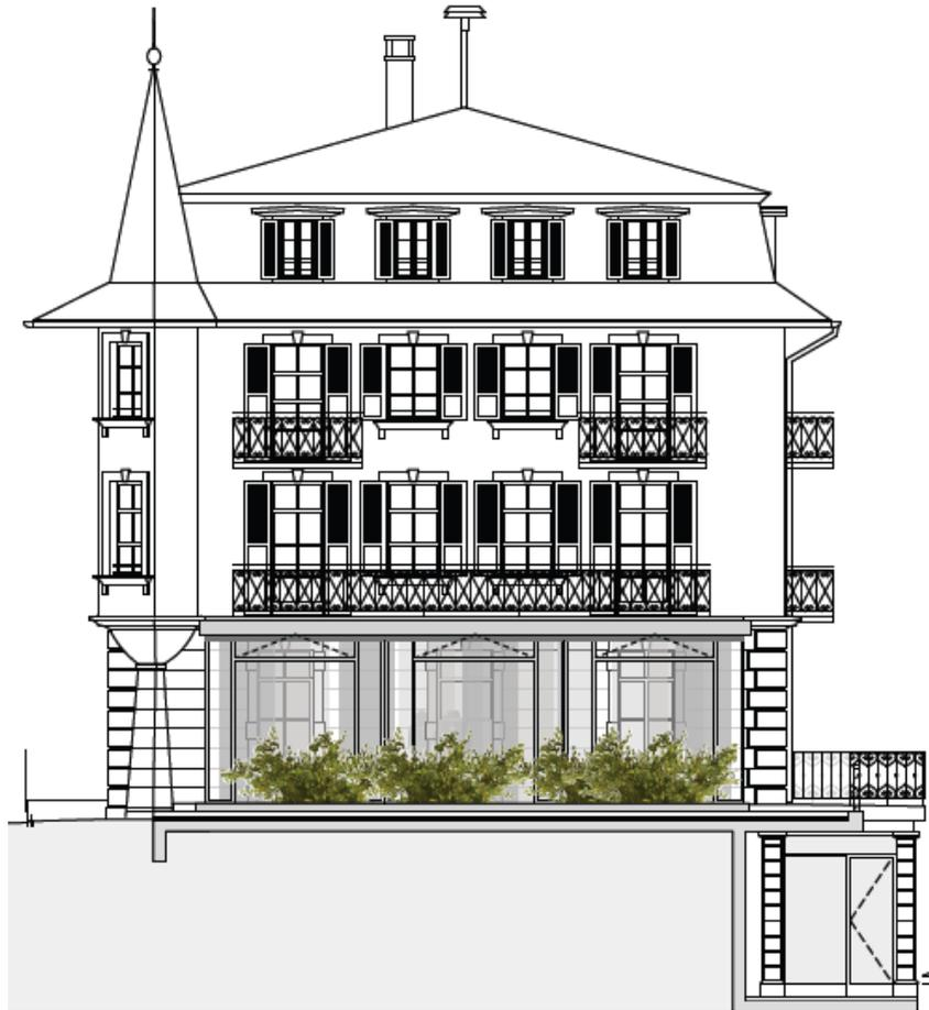
Die Gestaltung der Süd-Fassade (Taleinwärts) fällt durch den Erweiterungsbau im Erdgeschoss auf. Der Anbau ist in Absprache mit der Kantonalen Denkmalpflege gestaltet worden und dient der Unterbringung von Arbeitsplätzen der Bauverwaltung (siehe Erdgeschoss). Die gewählte Konstruktion mit raumhoher Verglasung erinnert in Grösse und Bauweise an die ehemalige Veranda des Hotels Adler. Sonnenschütze und leichte Vorhänge verhindern den direkten Einblick und gewährleisten ein angenehmes Arbeitsklima.
