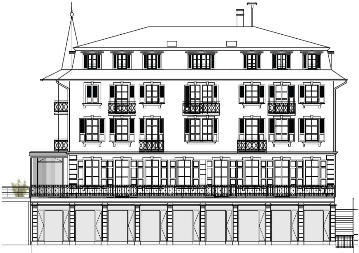
Markante Änderung an der Ost-Fassade (Bahnseite) ist die Gestaltung im Bereich des Untergeschosses. Hier werden die heute ausgemauerten Stützen freigelegt und die Zwischenräume verglast. Hinter dieser Glasfront befindet sich der grosse Sitzungsraum, der wie bereits erwähnt für Anlässe für bis zu 50 Personen genutzt werden kann. Diese Massnahme, im Zusammenhang mit dem Rückbau des heute an der Fassade entlang geführten Kamins, lässt die ganze Hausfront leicht und ansprechend erscheinen.
